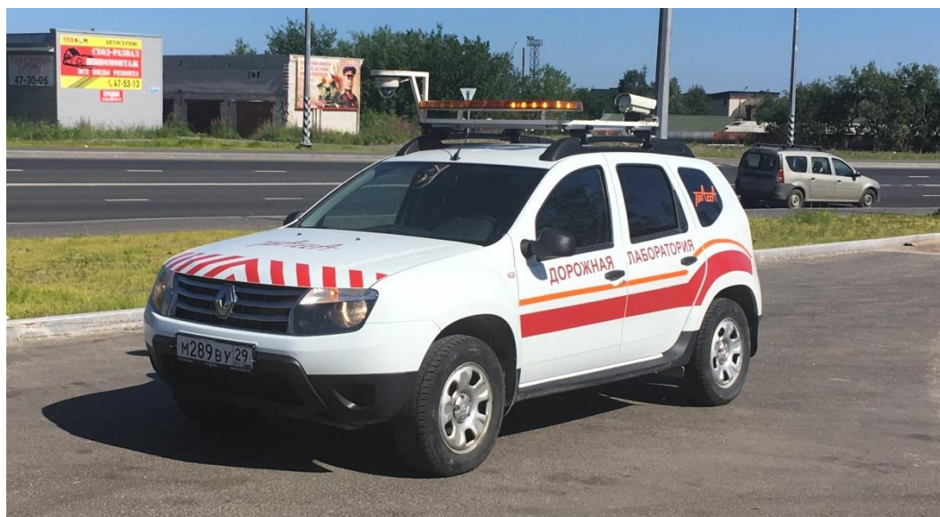
Рис. 1. Комплекс измерительный передвижной дорожной лаборатории «Трасса»
