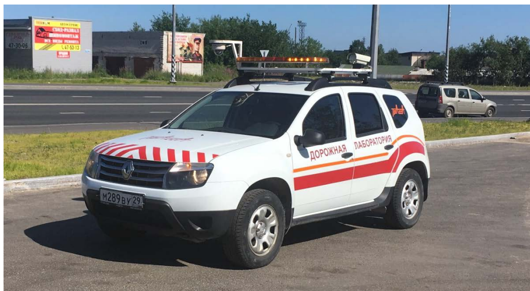
Рис. 1. Комплекс измерительный передвижной дорожной лаборатории «Трасса»
